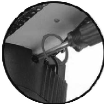
bg/ опъване на веригата en/ tensioning of the chain
