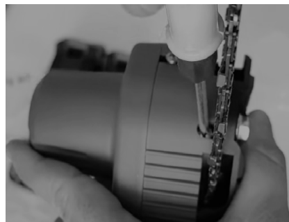
bg/ опъване на веригата en/ tensioning of the chain
